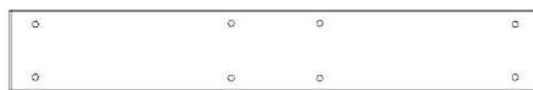
G2 | SUPPORT DE POUTRE DE LA BALANÇOIRE - W4L13108 (1) | 1 po x 5 1/4 po x 34 1/8 po (24x134x868)
